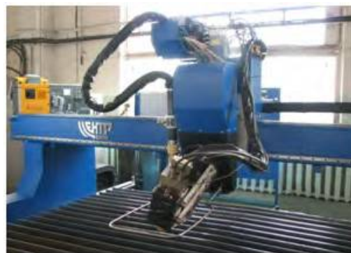
Рис. 1. Технологический комплекс плазменного раскроя материала с манипулятором для резки и разделки кромок заготовок под углом
