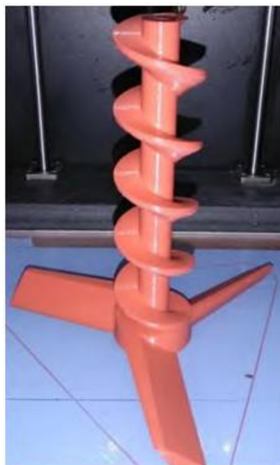
Рис. 8. Шнек для подачи формовочных смесей в строительном 3D-принтере
