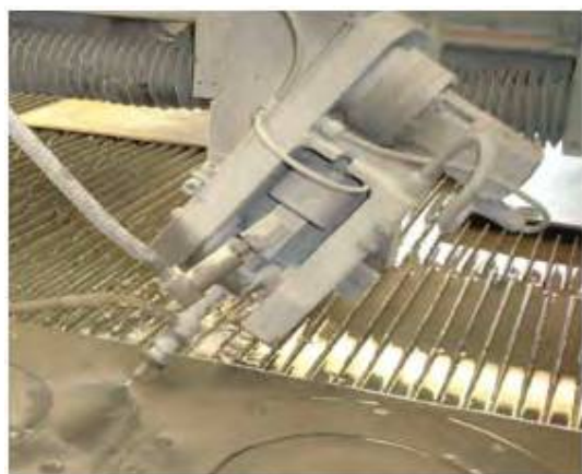
Рис. 4. Поворотная система сопла гидроабразивной резки
