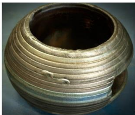
Рис. 1. Наплавленная поверхность элемента шарового крана и внутренний дефект в наплавленном слое
