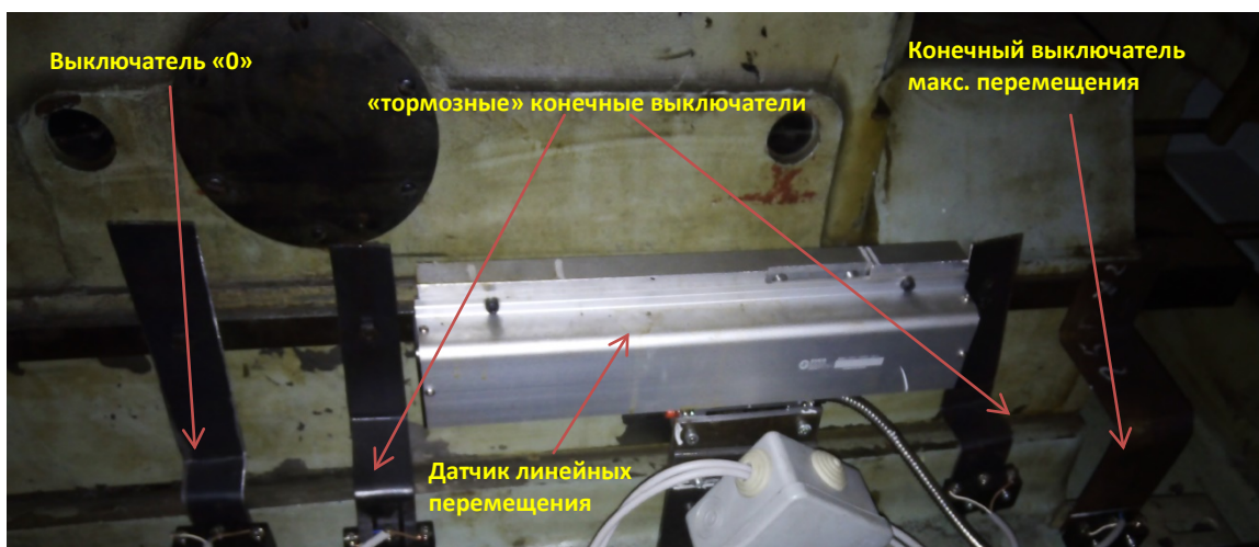
Рис. 2. Выключатели, определяющие конечное положение рабочего органа Fig. 2. Switches that determine the final position of the working body
