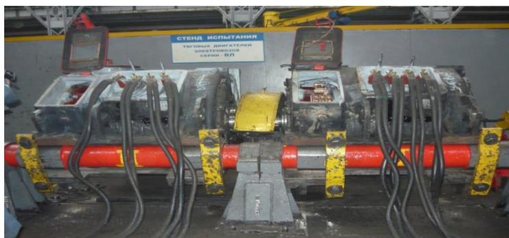
Рис. 2. Внешний вид стенда для испытания тяговых электродвигателей
