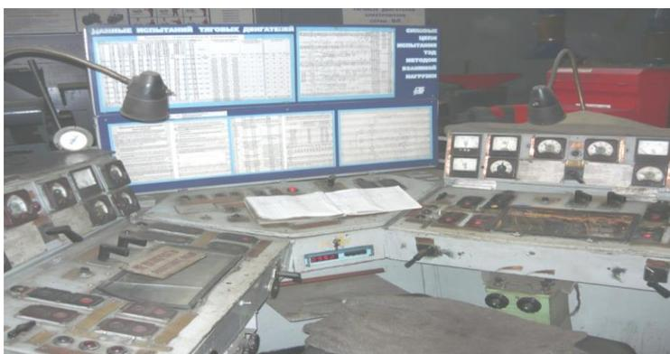
Рис. 1. Информационно-вычислительная часть стенда для испытания тяговых электродвигателей
