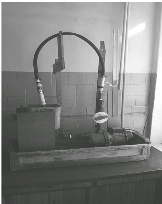
Рис. 1. Общий вид (а) и схема (б) экспериментальной установки для нанесения покрытий на золотники: 1 – основание; 2 – мотор-насос; 3 – ванна (0,01 м 3 ); 4 – всасывающий трубопровод; 5 – подающий трубопровод; 6 – кран регулировочный; 7 – диск со шкалой; 8 – ячейка; 9 – клемма питания анода; 10 – клемма питания катода; 11 – кран сливной; 12 – термометр; 13 – контактный нагреватель; 14 – уровень электролита
