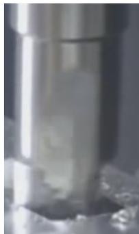
Рис. 6. Фрезерование квадратного паза
