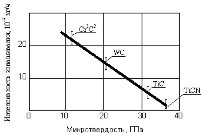
Рис. 2. Влияние микротвердости твердой фазы на величину интенсивности изнашивания покрытий (порошки плакированы никелем 30...35 мас.%)
