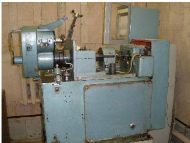
Рис. 3. Машина трения СМЦ-2 предназначена для испытаний материалов на трение и изнашивание при качении, качении с проскальзыванием и скольжении
