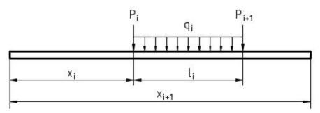
Рис. 2. Нагрузки, используемые при решении задачи идентификации
