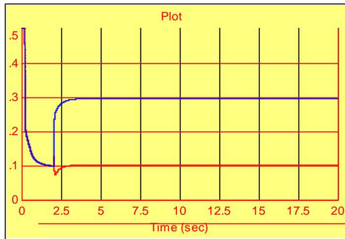
Рис. 7. Силы тяги по бортам при одновременном управлении по отклонению курсового угла и угловой скорости
