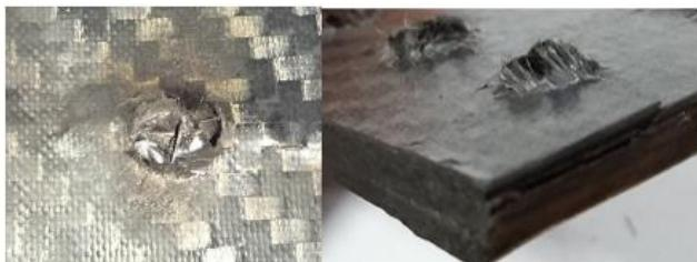
Рис. 3. Вид кромок образцов углепластика после сверления 40...50-ти отверстий
