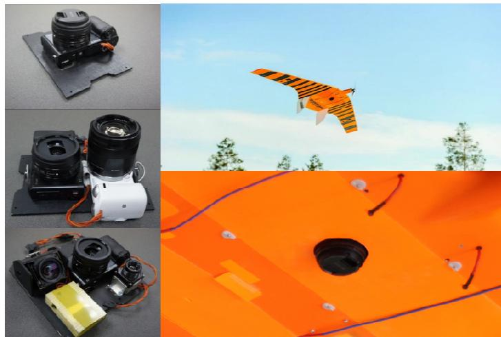
Рис. 1. Установка фотокамеры на беспилотный аэрофотосъемочный комплекс Supercam S350
