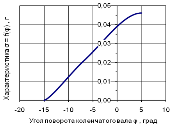
Рис. 2. Характеристика впрыска топлива
