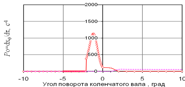
Рис. 5. Функция скорости выгорания паров топлива (образовавшихся за период \tau_i ) P_0 и функция P_2
