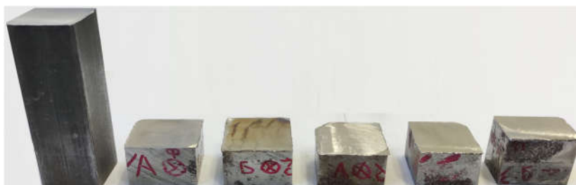
Рис. 3. Образцы после фрезерования: сталь 45, ACM-10, ACM-11, ACM-14, ACM-15 Fig. 3. Samples after milling: steel 45, ASM-10, ASM-11, ASM-14, ASM-15
