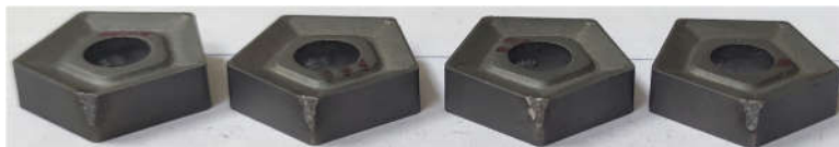
Рис. 4. Износ пластин после фрезерования наплавленного слоя ACM-11, 24-ый проход Fig. 4. Wear of plates after milling the deposited layer of ASM-11, 24th pass
