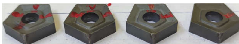
Рис. 5. Износ пластин после фрезерования наплавленного слоя ACM-14, 24-ый проход Fig. 5. Wear of plates after milling the deposited layer of ASM-14, 24th pass
