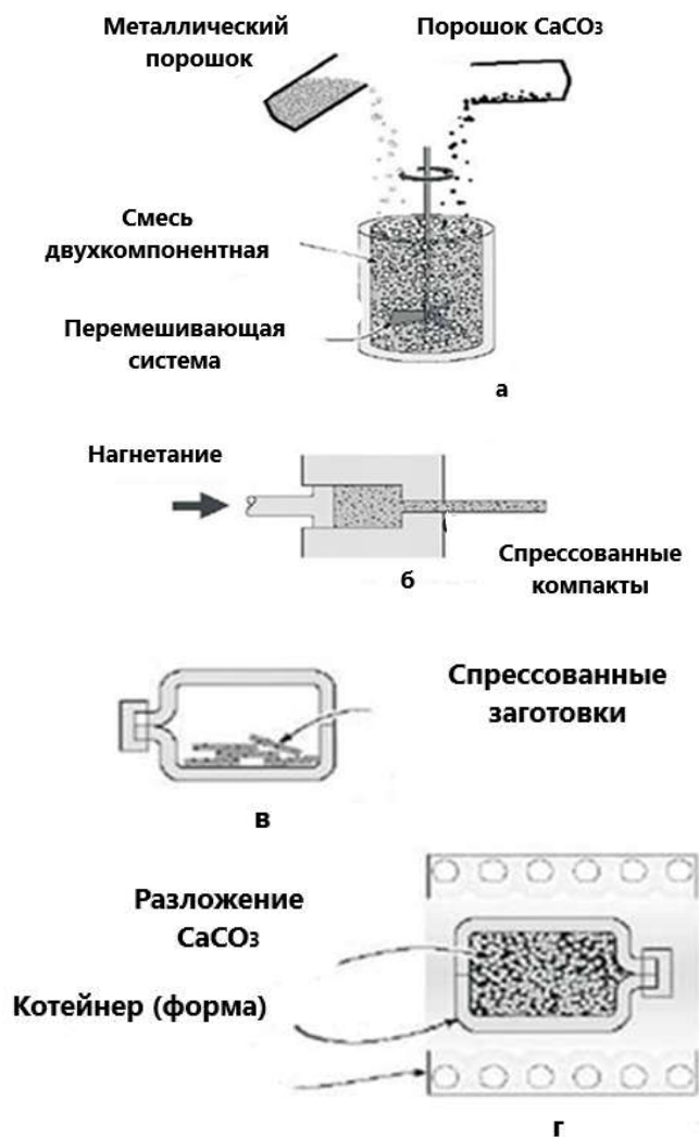
Рис. Вспенивание консолидированных металлического порошка и \text{CaCO}_3 : а – смешивание порошков; б – получение компакта продавливанием через фильеру; в – укладка формованных изделий в контейнер; г – пенообразование в печи [1]
