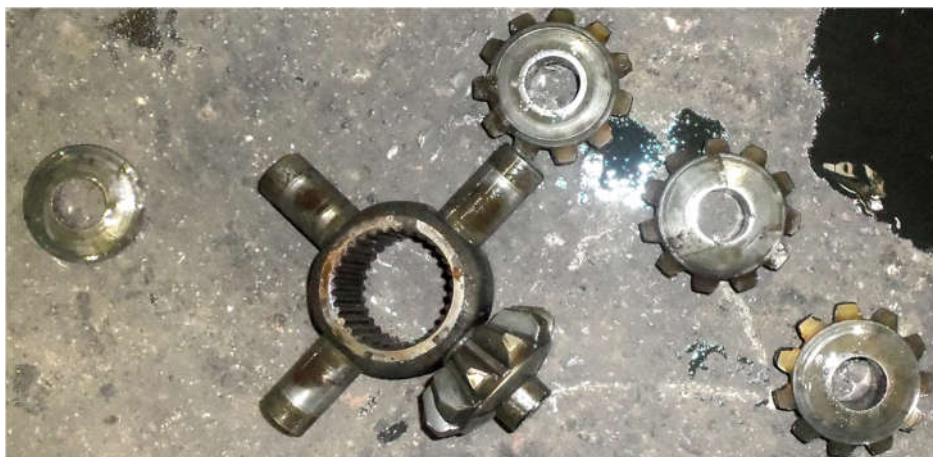
Рис.1. Детали пар трения дифференциала транспортно-технологической машины Fig. 1. Details of the friction pairs of the transport and technological machine differential
