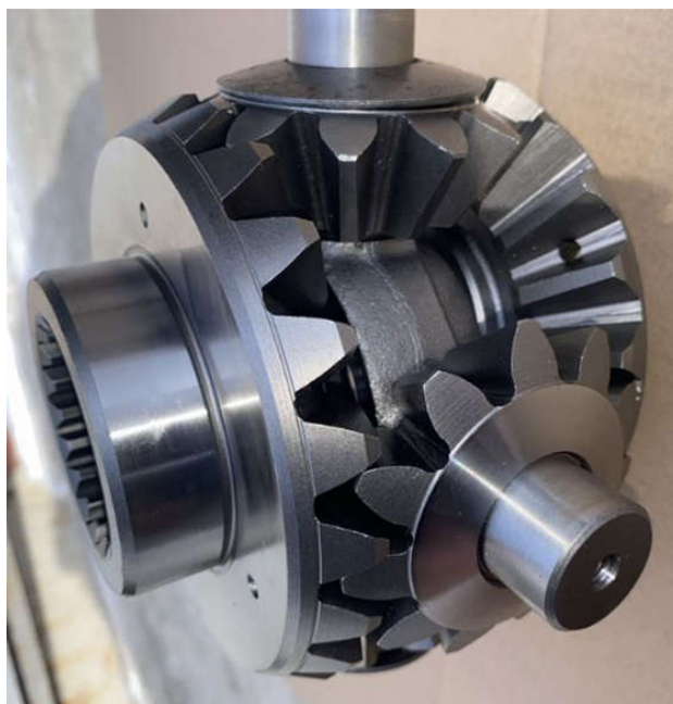
Рис.2. Трибосопряжения шестерен дифференциала Fig.2. Differential gear tribos
