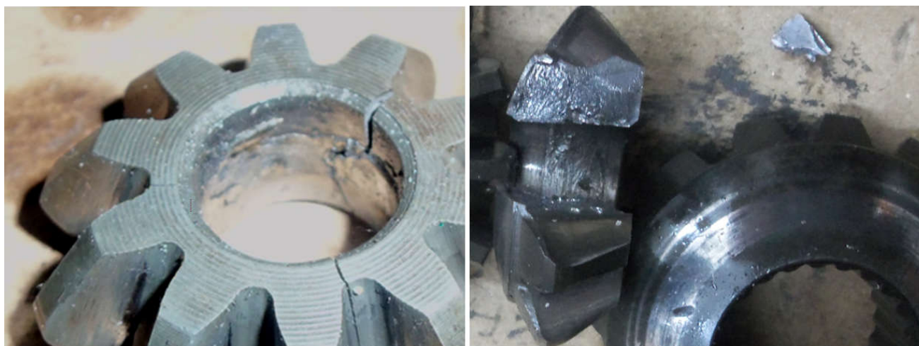
Рис. 3. Вид поверхностей трения шестерен дифференциала вследствие заедания Fig. 3. View of the friction surfaces of the differential gears due to binding
