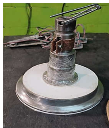
Рис. 2. Схема нанесения износостойких сплавов на рабочую поверхность ролика (а) и общий вид детали (б): 1 – вал ролика; 2 – защитное покрытие; 3 – защитные чехлы; 4 – упрочняемая поверхность
