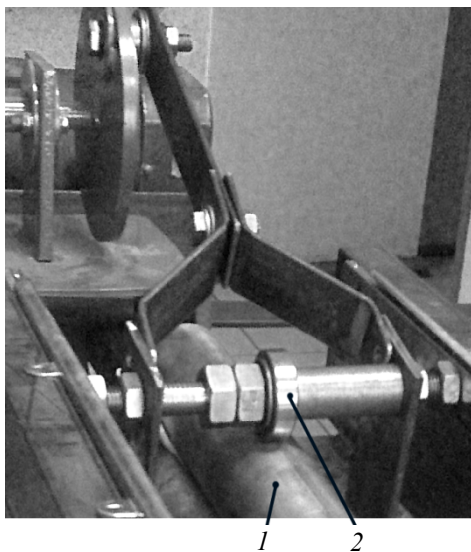
Рис. 4. Внешний вид испытательного узла стенда: 1 – цилиндрический образец (направляющая); 2 – нагружающий ролик
