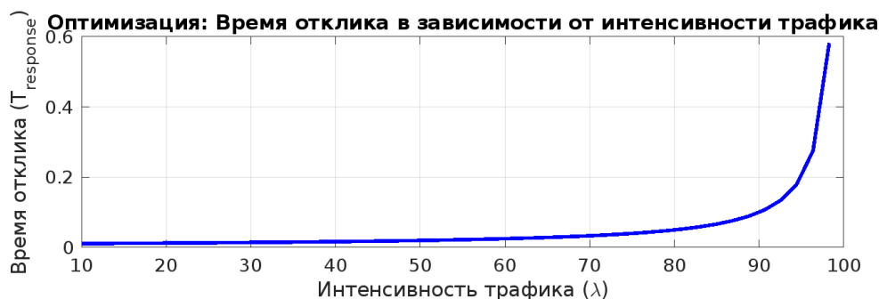
Рис. 6. Оптимизация определением времени отклика в зависимости от интенсивности трафика Fig. 6. Optimization by determining response time depending on traffic intensity
