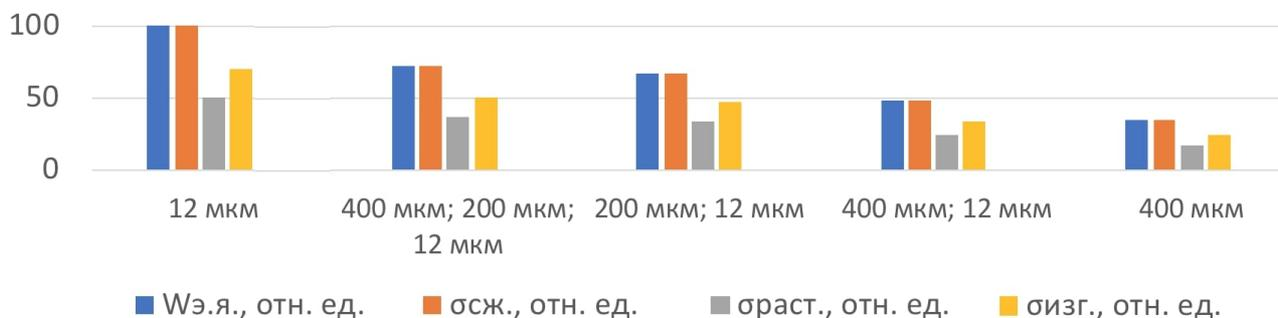
Рис. 5. Сопоставление экспериментальных данных о прочностных характеристиках ДУПКМ с результатами численного моделирования энергетических характеристик ДУПКМ
