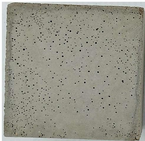
Рис. 5. Внешний вид бетона после добавления в масло АУ добавки №1 в концентрации 10%. Поверхность бетона гладкая и легко отделяется от опалубки, но видно большое количество пор из-за заземленного воздуха
