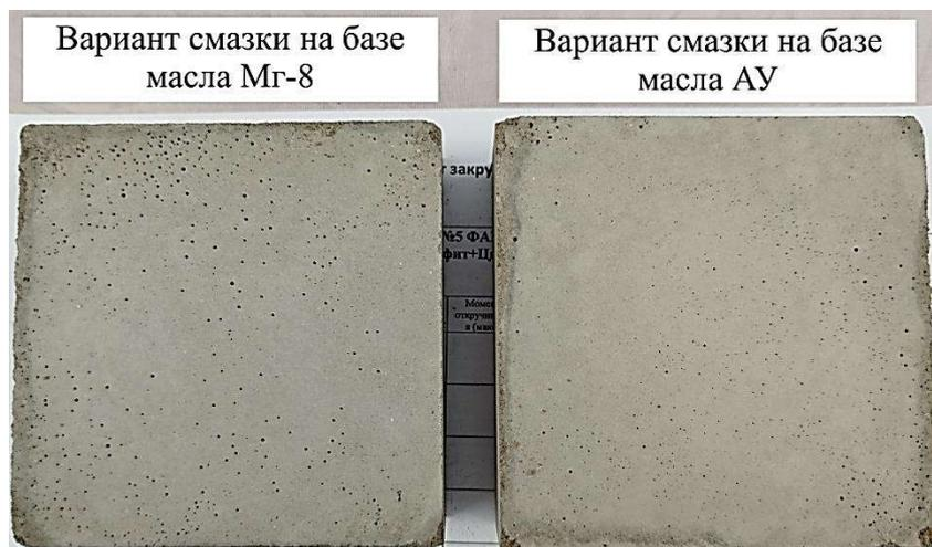
Рис.6. Сравнение смазок на основе разных масел
