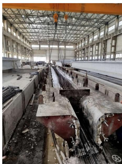
Рис. 8. Опалубка, используемая для проведения промышленных испытаний.
