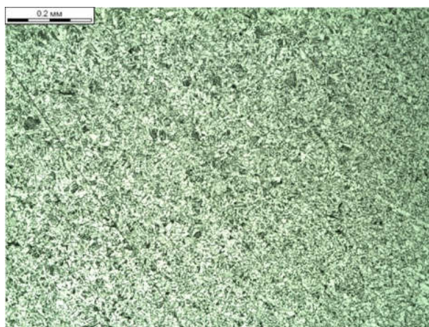
Рис. 1. Микроструктура исходной стали 10кп, используемой в эксперименте, \times 100 (травление: здесь и далее 4 % спиртовой раствор азотной кислоты)
