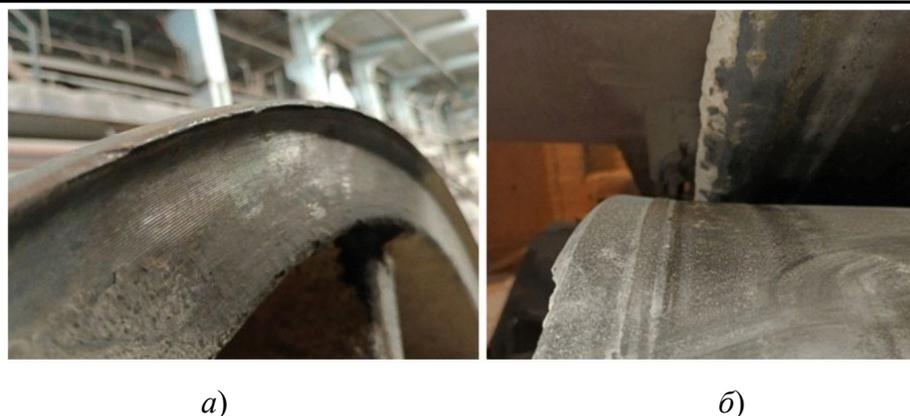
Рис. 8. Результат деформации верхнего (а) и нижнего (б) опорных роликов
