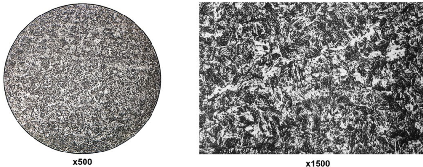
Рис. 6. Микроструктура стали 20X после закалки и высокого отпуска
