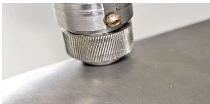
Рис. 5. Зона контакта устройства ППУ и контрольного образца
