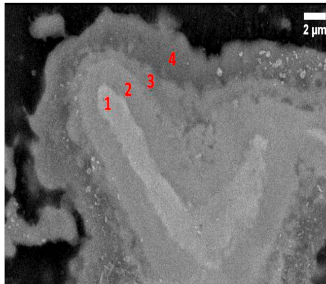
Рис. 2. Сканирующая электронная микроскопия типичной частицы меди в центральной части зоны перемешивания сплава 1565чН2
