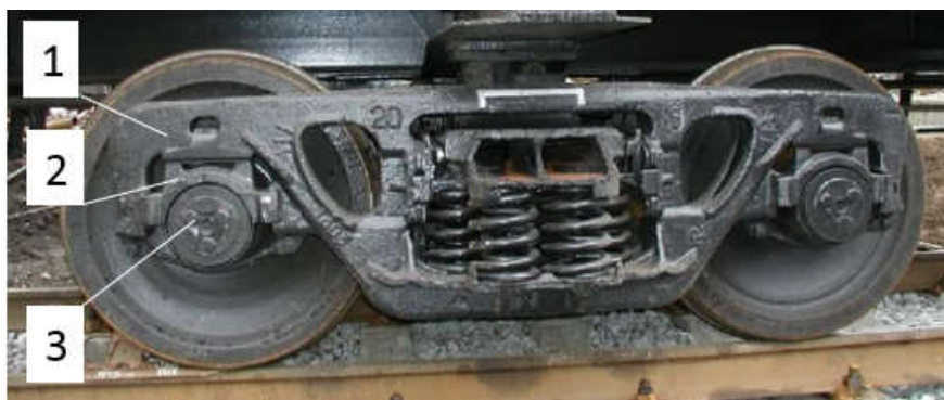
Рис. 1. Общий вид установки буксового подшипника кассетного типа в буксовом узле грузового вагона:
