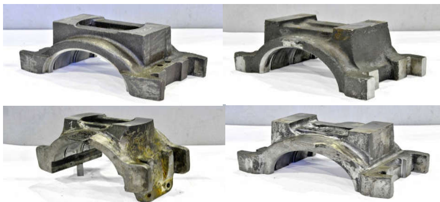
Рис. 4. Общий вид адаптеров различного конструктивного исполнения, установленных в буксовых узлах испытываемых вагонов
