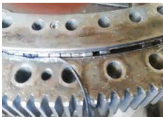
Рис. 6. Катастрофические отказы опорно-поворотного устройства: а – выпадение тел качения из кассет (сепараторов); б – выдавливание уплотнителя
