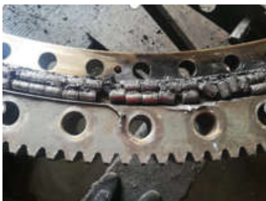
Рис. 6. Катастрофические отказы опорно-поворотного устройства: а – выпадение тел качения из кассет (сепараторов); б – выдавливание уплотнителя
