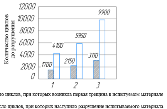
Рис. 9. Результаты циклических испытаний стали 30ХГСА:
