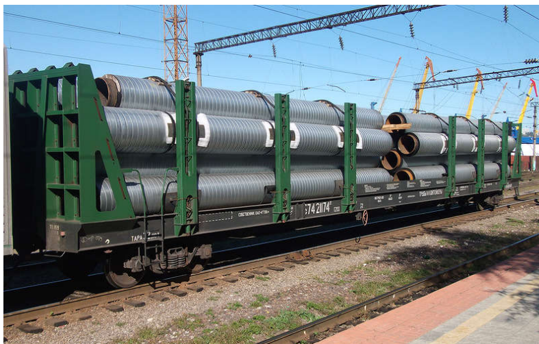
Рис.1. Вагон-платформа для перевозки труб большого диаметра модель 13-1163 Fig.1. Platform wagon for transporting large diameter pipes model 13-1163
