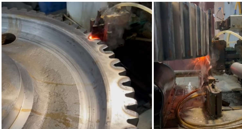
Рис. 1. Упрочнение зубьев зубчатого колеса токами высокой частоты (ТВЧ) с помощью универсального закалочного станка Fig. 1. Hardening of the gear wheel teeth by high frequency currents (HFC) using the universal quenching machine
