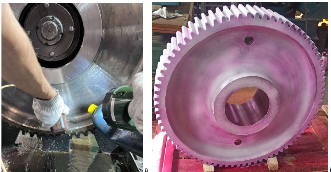
Рис. 9. Неразрушающий контроль диска зубчатого колеса магнитопорошковым (а) и капиллярным (б) методами Fig. 9. Non-destructive testing of the gear disk by magnetic powder (a) and capillary (b) methods
