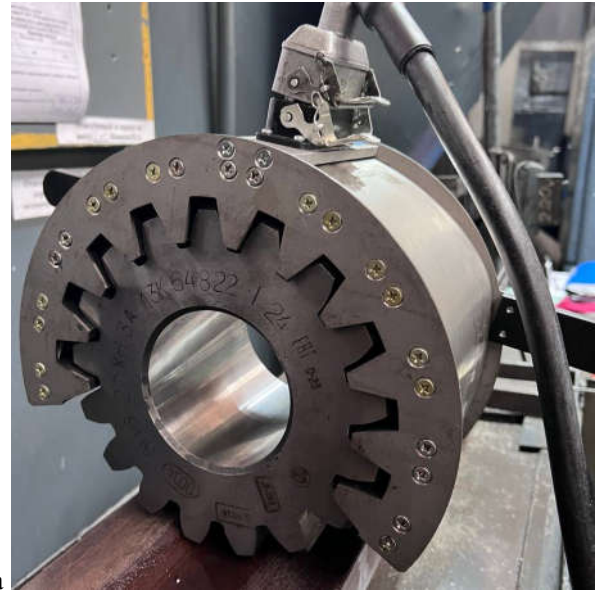
Рис. 7. Намагничивание венца зубчатого колеса (а) и шестерни (б) с помощью индуктора дефектоскопом УМДЗ
