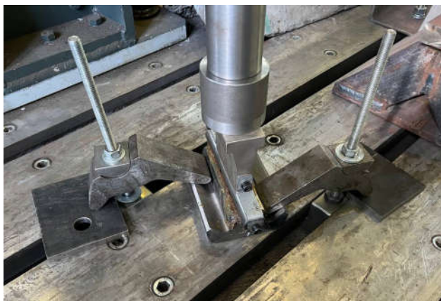
Рис. 4. Циклические испытания фрагмента шестерни на изгибную усталость при помощи универсальной разрывной машины ТС244.31А
