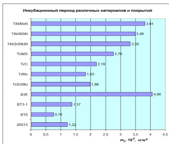
Рис. 2. Сравнительная эрозионная стойкость типичных лопаточных материалов (20X13; BT6; BT3-1; ВЗК) и нанокompозитных ВИП-покрытий различных систем по результатам стендовых испытаний на каплеударную эрозию
