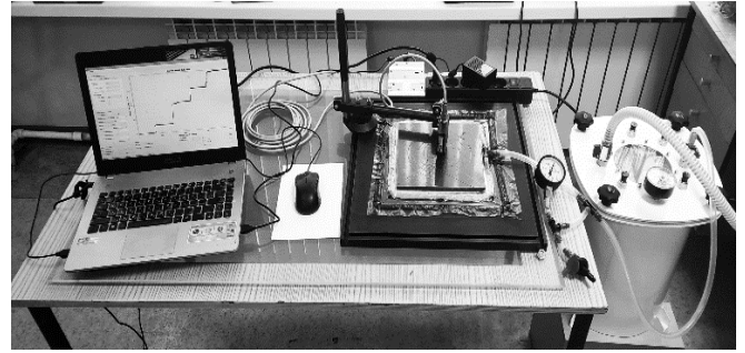
Рис. 6. Общий вид установки для измерения сжимаемости композитных преформ
