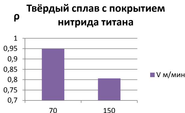
Рис. 10. Насыщение поверхности металлокерамики изделий маслом после механообработки твёрдым сплавом с покрытием нитрида титана
