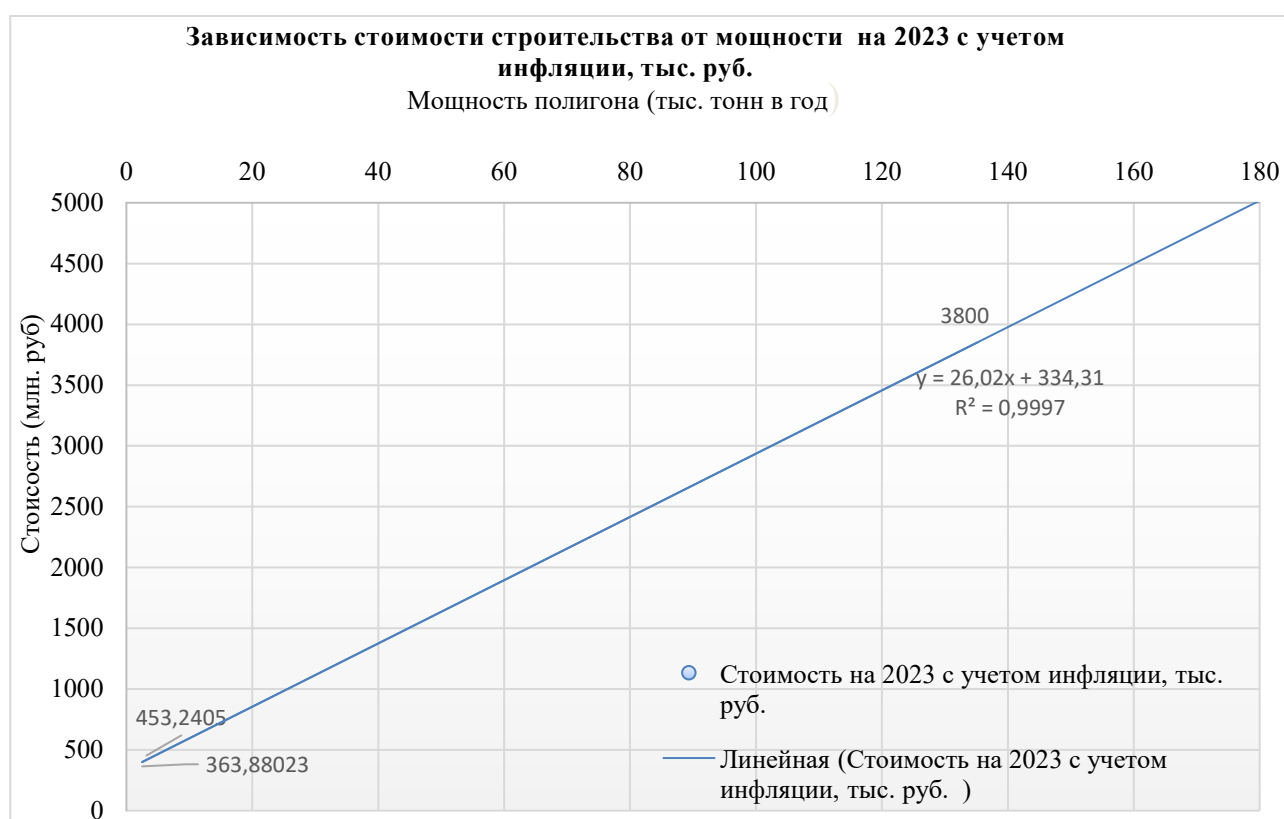
Рис. 7. Линия тренда стоимости строительства полигона от мощности Fig. 7. Trend line of landfill construction cost versus capacity
