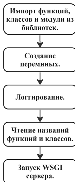
Рис. 2. Последовательность процессов, необходимая для запуска приложения Fig. 2. The sequence of processes required to launch the application
