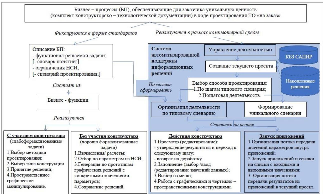
Рис. 14. Особенности организации деятельности конструктора технологической оснастки (ТО) при переходе из традиционной («бумажной») среды проектирования в среду компьютерную
