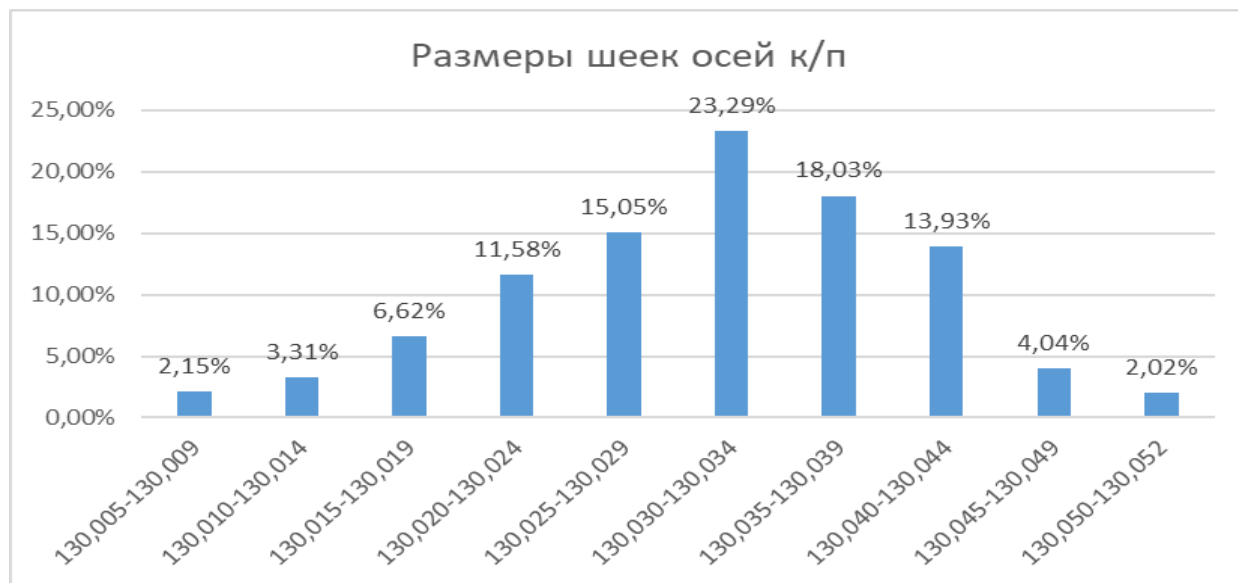
Рис. 1. Гистограмма распределения размеров шеек осей колесных пар пассажирских вагонов, находящихся в эксплуатации
