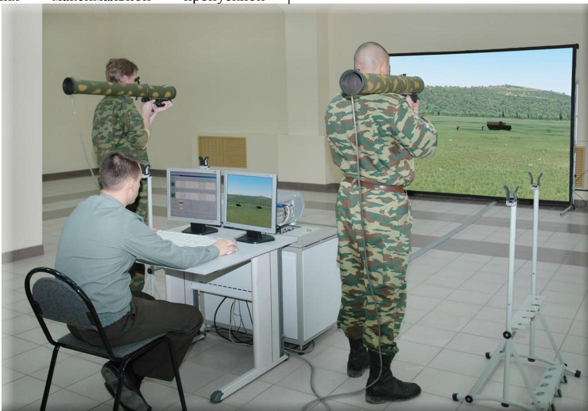
**Рис. 5. Тренажер для подготовки огнеметчиков РПО-А, классный**
