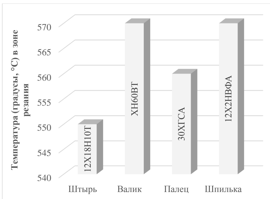
Рис. 1. Минимальные значения температуры в зоне резания при шлифовании разными абразивными инструментами заготовок деталей, выполненных из разных материалов
