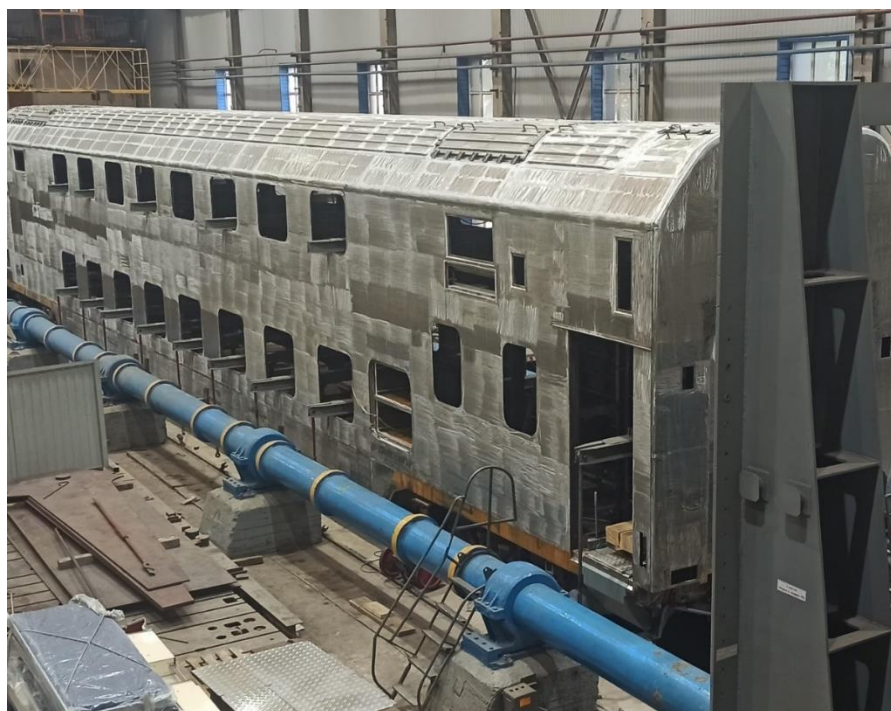
Рис. 3. Натурные стендовые испытания несущей конструкции кузова двухэтажного вагона
