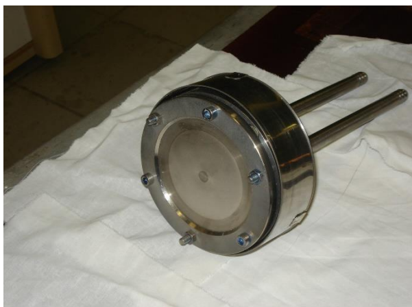
Рис. 4. Магнетрон M100FS, оснащенный круглой хромовой мишенью Fig. 4. Magnetron M100FS equipped with a round chrome target
