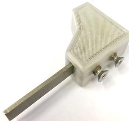
Рис. 3. Закрепленный образец в приспособлении
