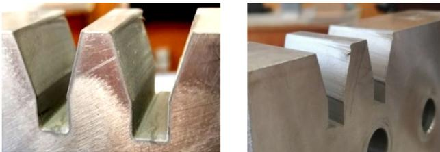
Рис. 8. Фотография образца с вырезанными предварительным профилем пазами
