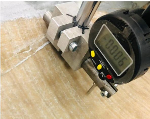
Рис. 4. Устройство контроля ИЧЦ-0-25 0,001
