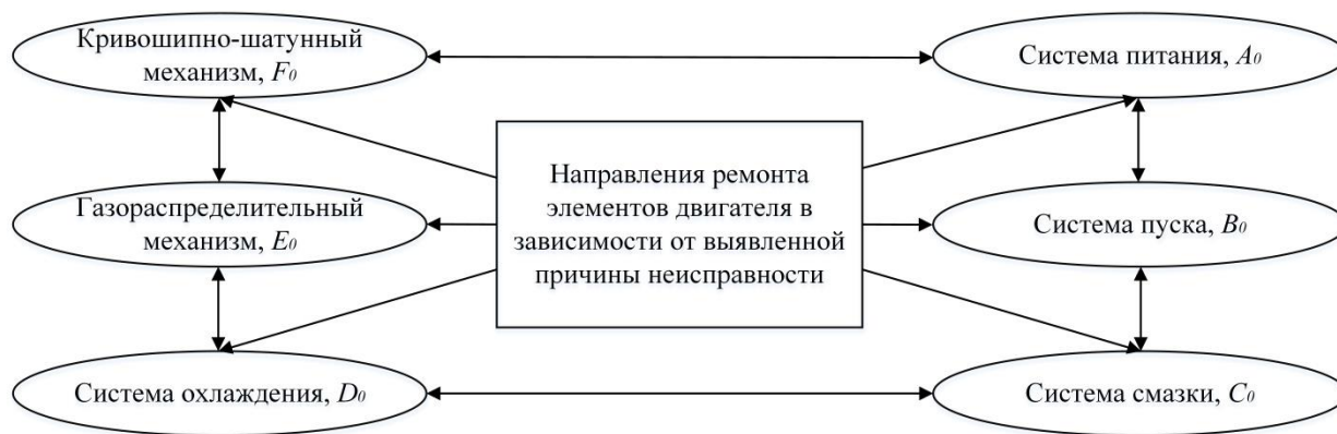
Рис. 1. Система текущего ремонта двигателя внутреннего сгорания Fig. 1. Internal combustion engine maintenance system
