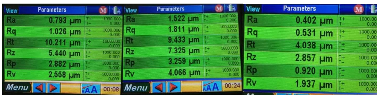
Рис. 3. Результаты измерения образцов после КО (скриншоты с экранов профилографа)
