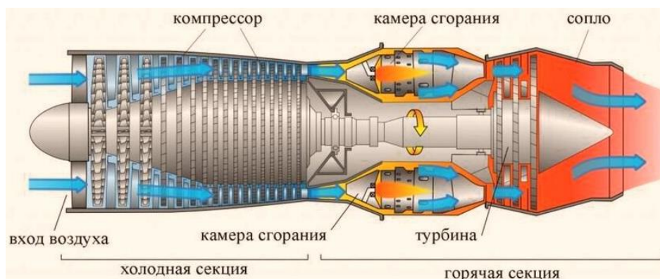
Рис.1. Конструкция турбореактивного двигателя
