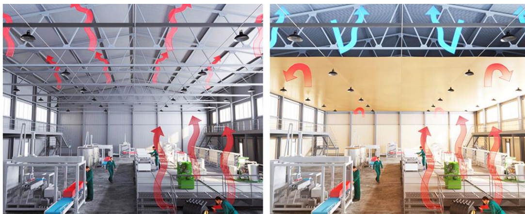
Рис. 1. Предполагаемые потоки тепловой энергии в производственном здании до и после установки натяжного потолка
