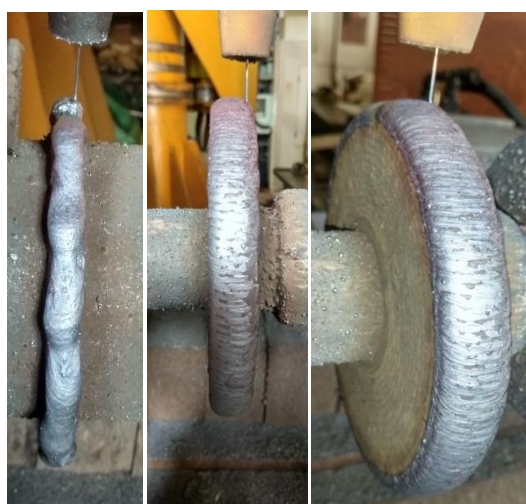
Рис.2. Результаты и схема наплавки при различных траекториях движения фидстока (сопла сварочной горелки):
