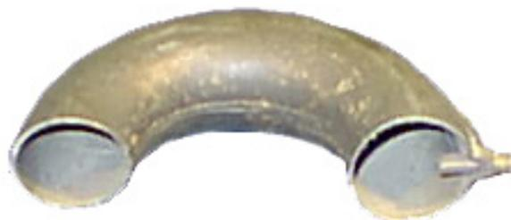
Рис. 3. Образец торовой сварной емкости
