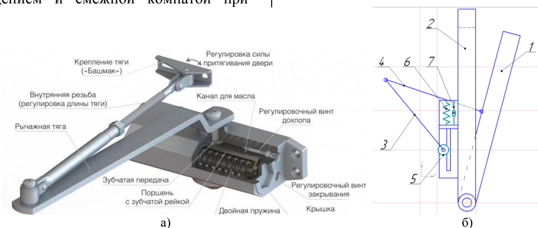
Рис. 1. Общий вид (а) и расчетная схема (б) механизма доводчика двери
