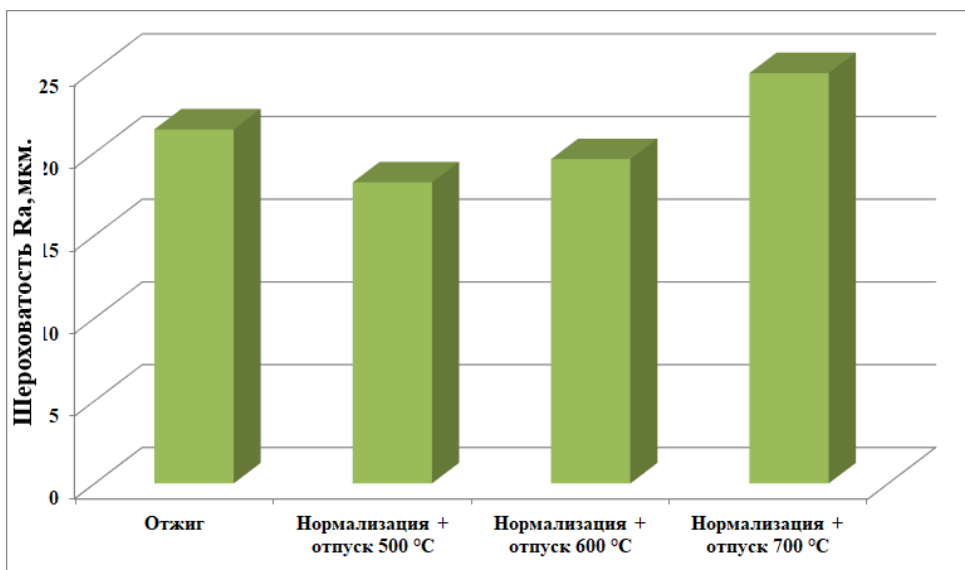
Рис. 7. Шероховатость поверхности после точения образцов, полученных при различных режимах термической обработки
