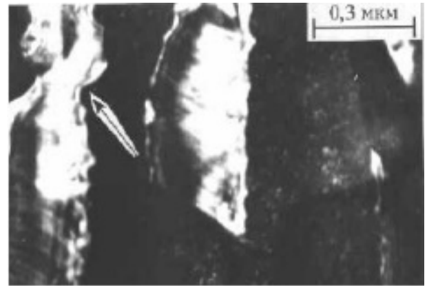
Рис. 3. Структура перлита после изотермического распада при 700 °С и дополнительного отжига при 700 °С в течении 30 ч, \times 60\,000 [10]
