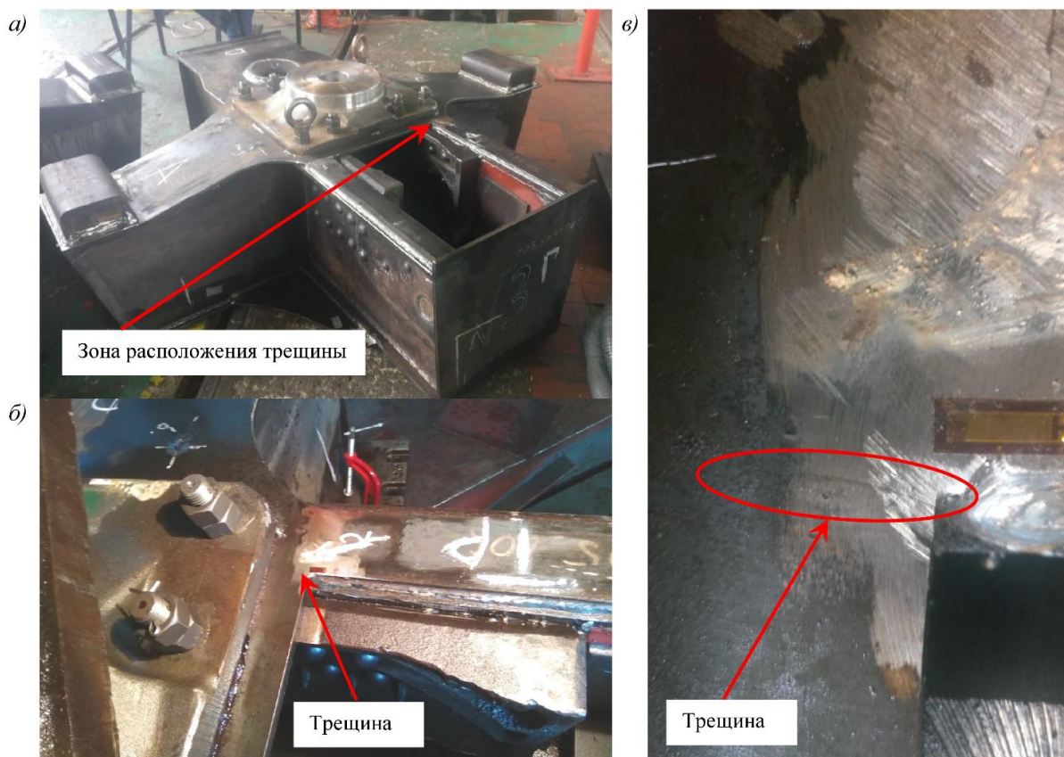
Рис. 5. Общий вид трещины в образце шкворневого узла
