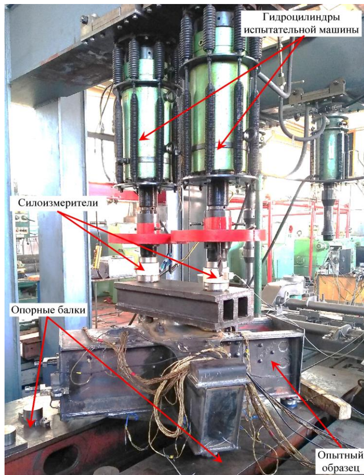
Рис. 3. Опытный образец, установленный в стенд
